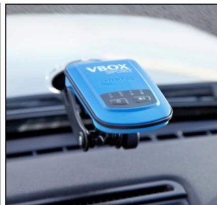
VBOX Sport は衛星シグナルを遮ることなく追尾できるよう常に操作面を上に向けて取り付けして下さい。吸盤（右上の写真参照）を使って取り付けることもできます。詳細については弊社までお問い合わせ下さい。
