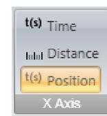
ラップを比較するのではない場合、時間で行くと便利です。距離と位置は同じサーキットで異なるラップ同士を比較するのに便利です。今まではラップ比較を行うのに走行距離が使われてきましたが、GPSの登場により、GPSポジションを使う方法がより便利な方法となりました。これは、走行距離は走行するラインにより少しずつ変化してしまうためです。ポジションの誤差は<3mで、走行距離誤差(しばしば>10m)より正確です。
